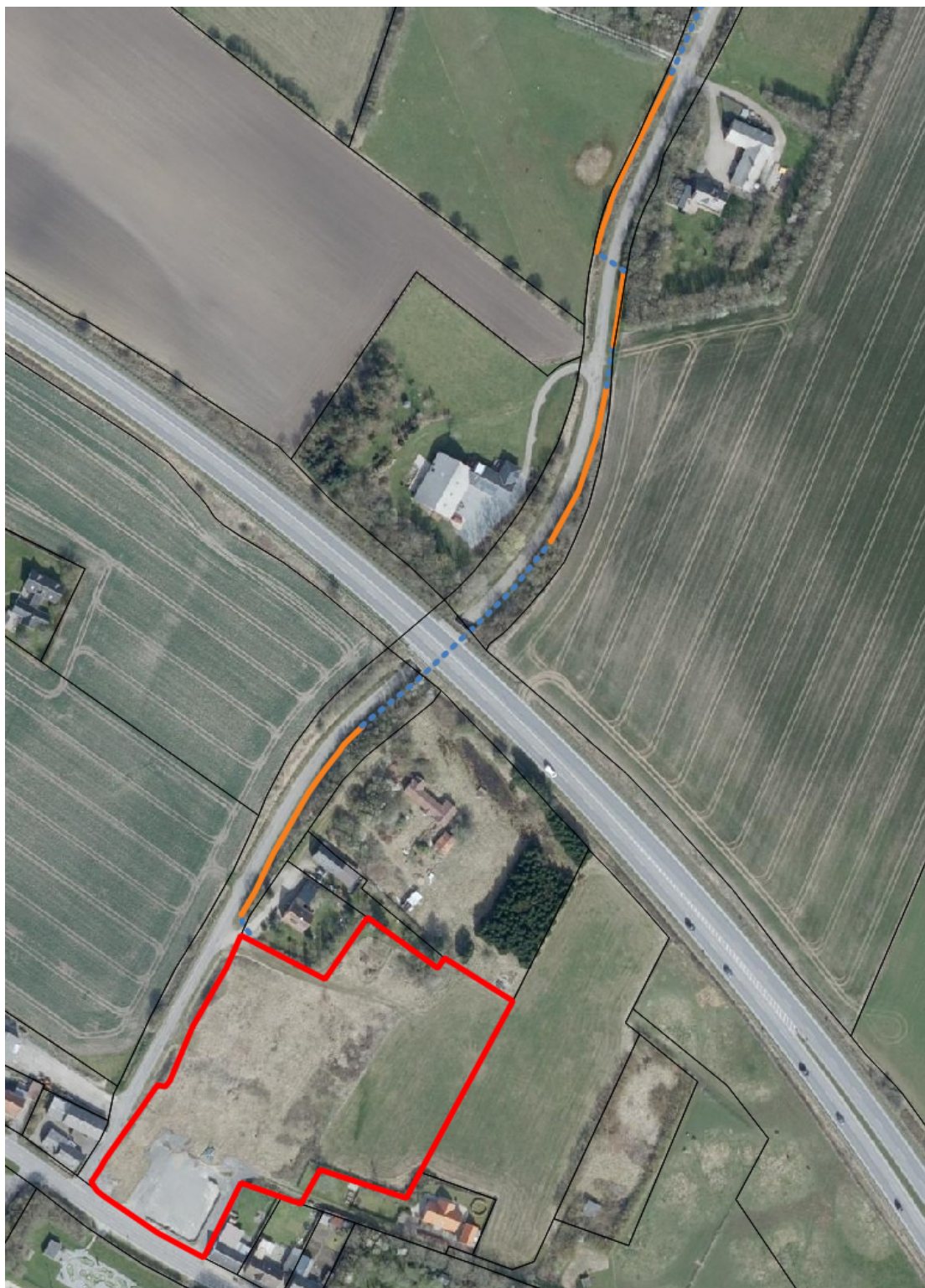
Bilag 1 1: Sydlige del af forløbet fra Sundbyvej 138, langs Nørrekærvej mod Klovenbakker. Rødt område: Matr. 22e, Sundby By, Sundby, den matrikel der skal bebygges. Blå stiplede linje: Rørlagt strækning af F269. Orange linje: Åben grøft.
