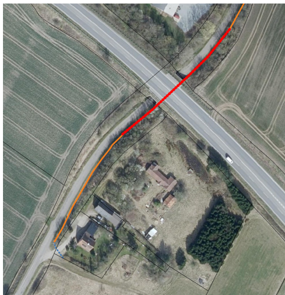
Figur 3: Rørlagt forløb under Rute 26. Rød stiplede linje: Rørlægningen der højest sandsynligt vil virke som en flaskehals for systemet.
