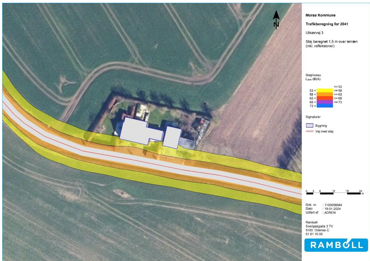
Figur 11. Støjberegning fra vejtrafikstøj for år 2041, Utkærvej 3.
