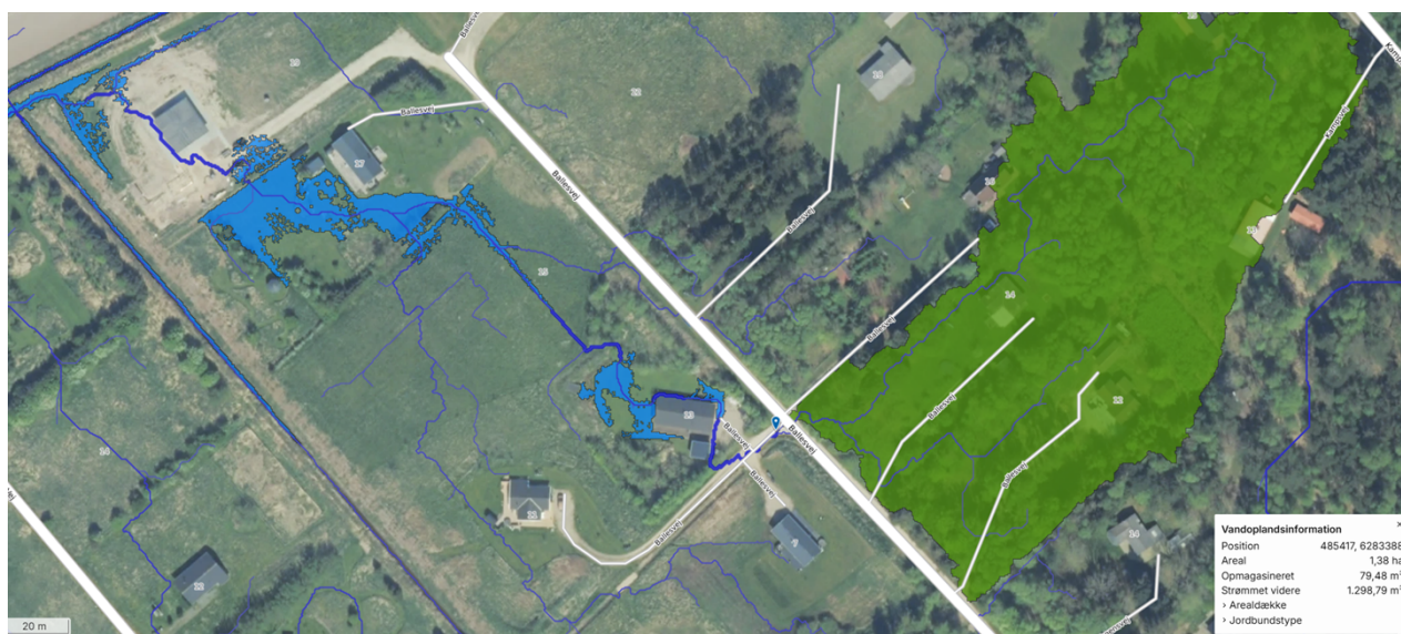
Figur 2. Stikvejen ved vejgrøftens start modtager regnvand fra et opland på ca. 1,38 ha.
