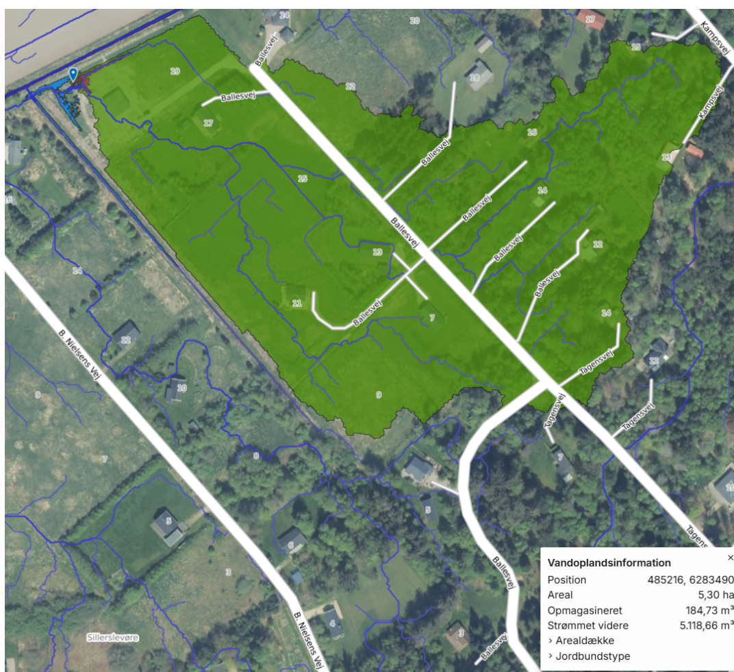
Figur 4. Ballesvej 7, 9, 11 og 13 afvander før etablering af vejgrøft til Kanal 4 ved udløb i Kanal 2 for et opland på samlet set ca. 5,3 ha.
