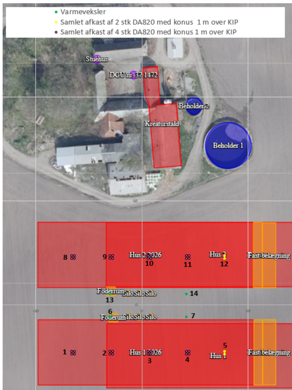
Oversigtstegning over placering af afkast i ansøgt scenarie
