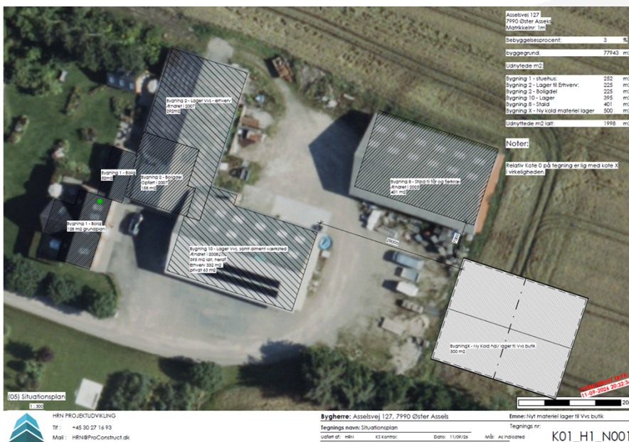
Lagerhallen opføres henholdsvis 7 meter og 29 meter fra eksisterende bygninger, som er placeret næved stuehuset. Ejendommen er visuelt afskærmet af høj beplantning mod nord, øst og vest og delvist mod syd.
